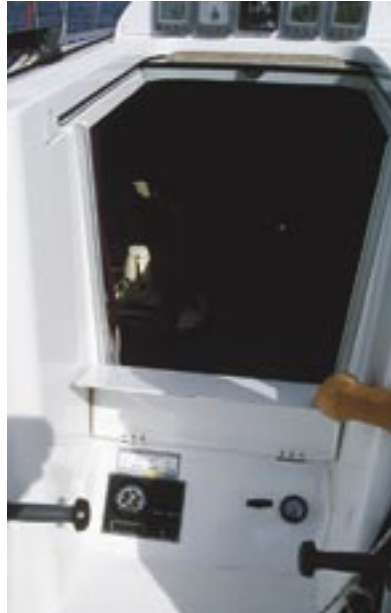
Die undurchsichtige Abdeckung erschwert das Ablesen der Drehzahl
