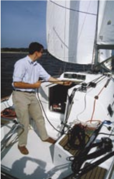
Die Fallwünsche sind gut erreichbar und in der richtigen Arbeitshöhe
